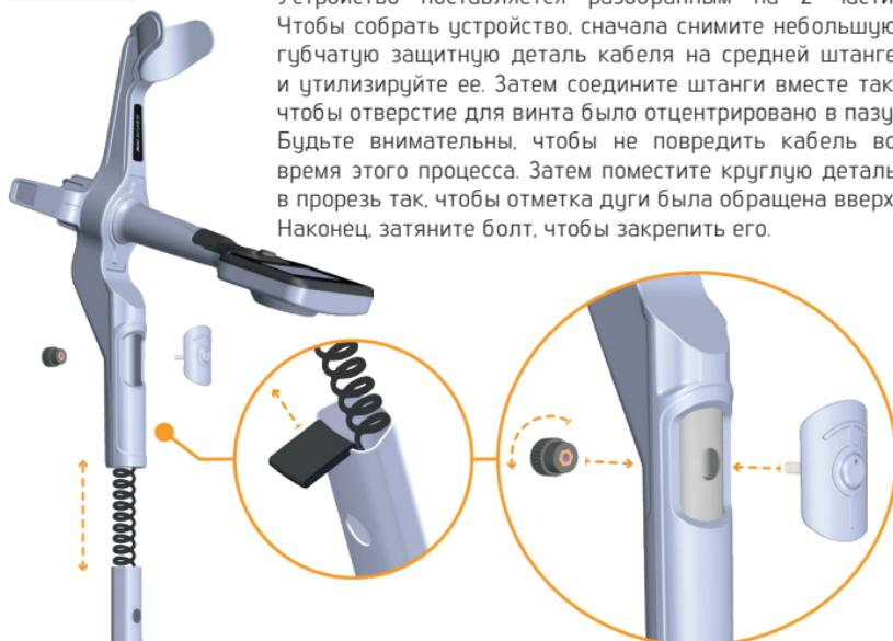
Чтобы отрегулировать длину штанги в соответствии с вашим ростом, откройте защелку рычага. Потяните нижнюю штангу вниз и после регулировки длины нажмите на фиксатор уровня, чтобы закрепить его. Не вытягивайте штангу за пределы отметки "max".
