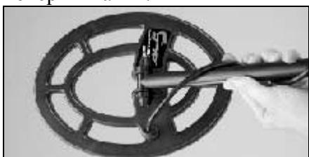
5. Вставьте штекер кабеля в разъем корпуса металлодетектора и надежно затяните его вручную.
