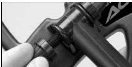
3. Вставьте верхнюю штангу в нижнюю штангу, а затем собранный таким образом узел вставьте в раму пульта управления детектора ACE, нажав две кнопки и соединив штангу с узлом корпуса. Отрегулируйте наиболее удобную для работы длину собранного узла.
