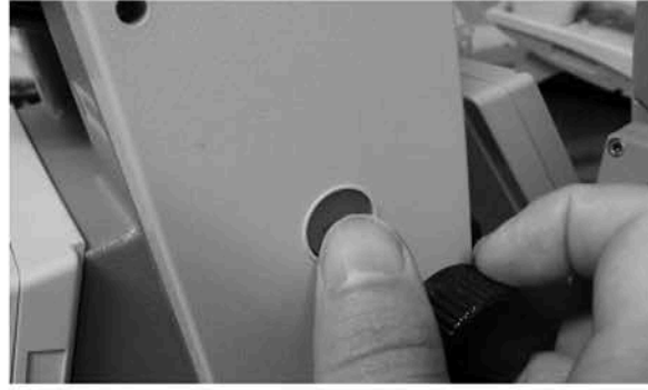
Рисунок 6 – Кнопка быстрых измерений тахеометра RTS332
