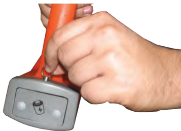
а) Выдвинуть фиксатор, освободить батарейный отсек
