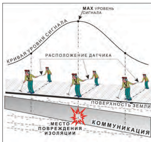
применение датчика-определителя дефектов коммуникации (ДОДК) методом тах
